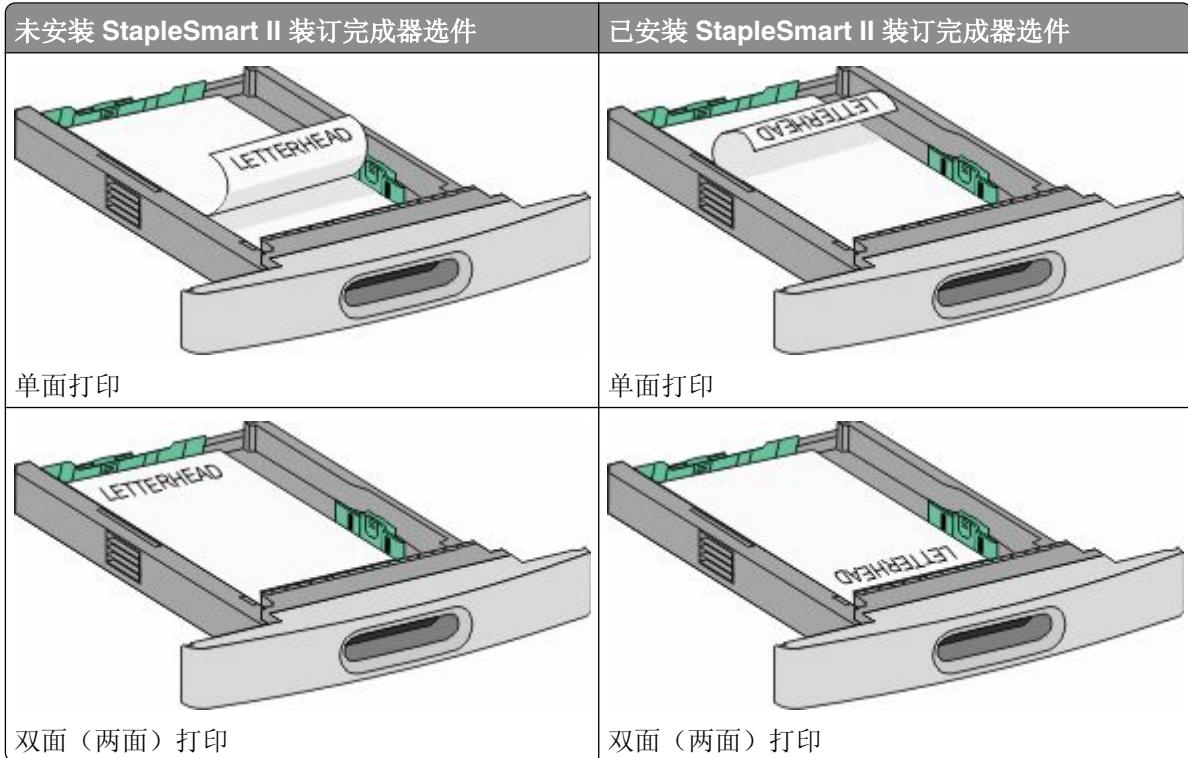
**注意：**请注意进纸匣侧面上的最高加载线，它指示加载纸张的最大高度。请不要过量加载进纸匣。
