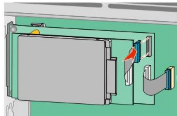
要将打印机硬盘直接安装到系统板上：
