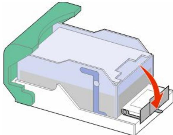
**5** 用力将订书钉盒托架推回到装订器部件中，直到订书钉盒托架发出“咔嗒”一声，卡入到位。
