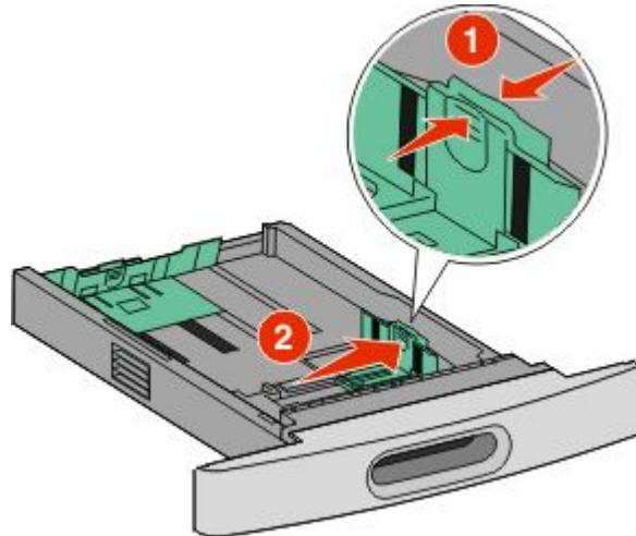
**3** 解锁长度导片，如图所示，向内压住长度导片凸柱，并将导片移动到与加载的纸张尺寸相符的正确位置上。
