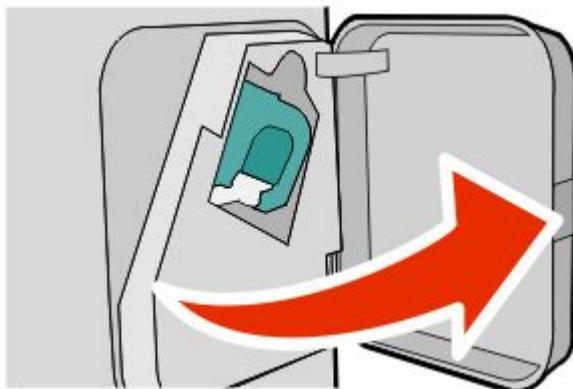
2 向下拉订书钉盒托架的插销，然后将托架拉出打印机。
