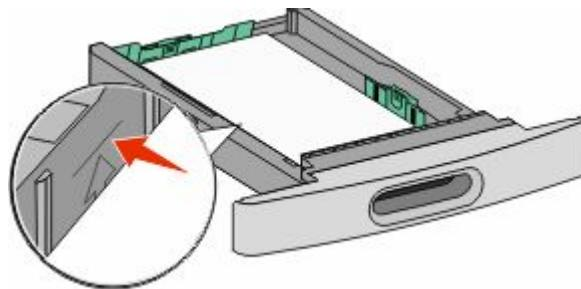
**6** 如果需要，请将纸张导片调整到轻轻地接触纸堆边缘的位置，然后为进纸匣上指示的纸张尺寸锁定长度导片。
