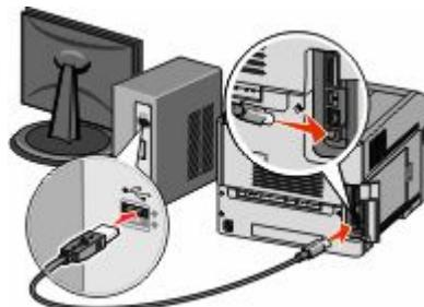
**注意:** 打印机被配置后, 软件将指导您断开临时的 USB 电缆连接, 这样您可以实现无线打印。
