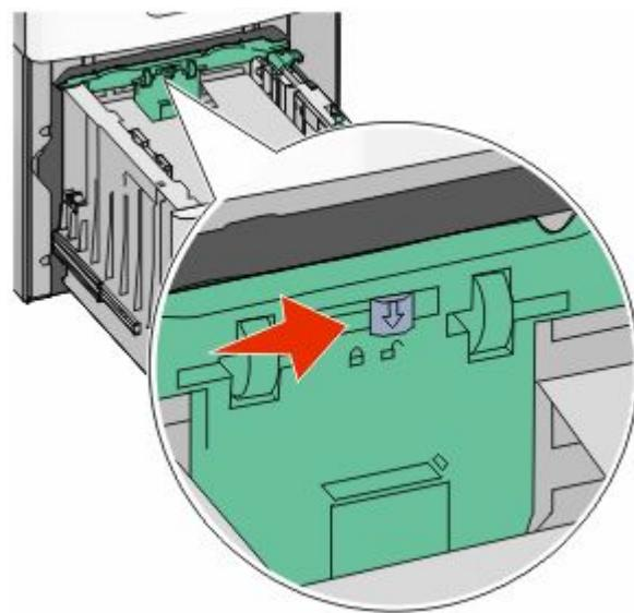
**4** 推长度导片释放销来升高长度导片，将导片滑动到与加载的纸张尺寸相符的正确位置上，然后锁定导片。
