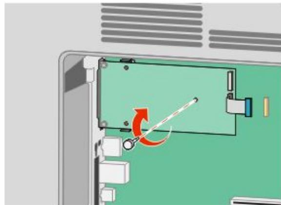
**9** 安装提供的两个螺钉来将 ISP 固定板固定在系统板框架上。
