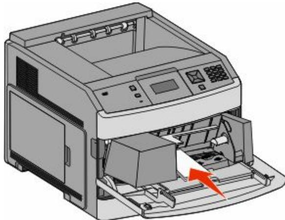
**注意：**不要通过用力将纸张压到纸堆高度限制器下面而超过最大纸堆高度。
