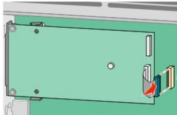
**12** 如果之前安装了打印机硬盘，则将打印机硬盘安装到 ISP 上。如需更多信息，请参阅第28页“安装打印机硬盘”。
