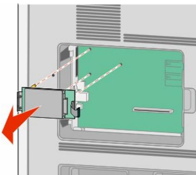
**d** 取下将打印机硬盘固定板安装到打印机硬盘上的翼形螺钉，然后取下固定板。将打印机硬盘放在一边。
